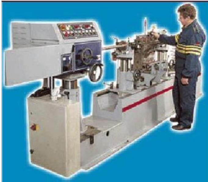
Slika 16. Mašina za trnovanje blokova BA 2000
